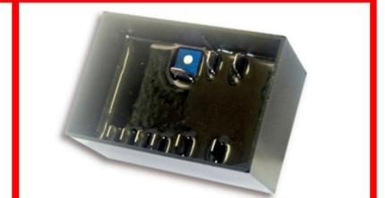
Per le auto equipaggiate con tachimetro elettronico, questa interfaccia provvedere a "pulire" il segnale, consente anche di pilotare 2 Rally Computers separati
